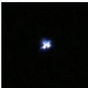
Тест свидетельствует о сильном астигматизме, вызванном в основном пережатиями элементов оптической схемы со стороны оправы главного зеркала и блока крепления вторичного зеркала. Для устранения ошибки пришлось снять главное зеркало телескопа. На фото внизу очень хорошо видна конструкция оправы. Зеркало держится резиновыми прокладками, поверх которых лежит металлическое кольцо, притянутое винтами к основанию.
