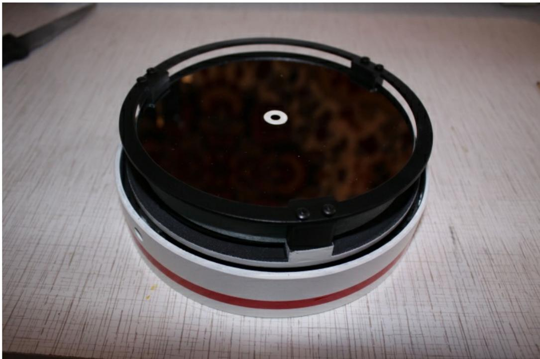
Результатом ремонта была установка дополнительной прокладки между главным зеркалом и металлом:
