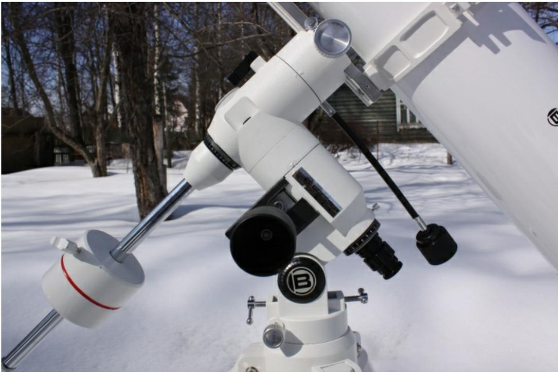
Винты выставления угла полярной оси по высоте снабжены ручками со свободным ходом, а по азимуту сами ручки винтов достаточно объемны, что позволяет с высокой точностью контролировать усилие и плавно навестись прямо на полюс. На фотографиях видны градуировочные круги для определения часового угла Полярной звезды, а также регулятор подсветки искателя полюса.
