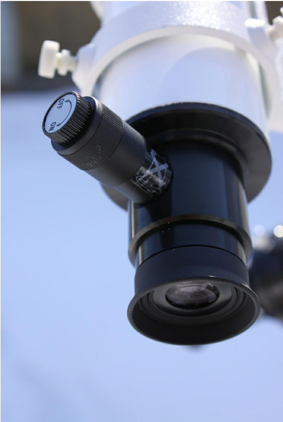
Крепление искателя к трубе осуществляется с помощью пары пластиковых винтов. Внутри трубы искателя достаточно комфортно.
