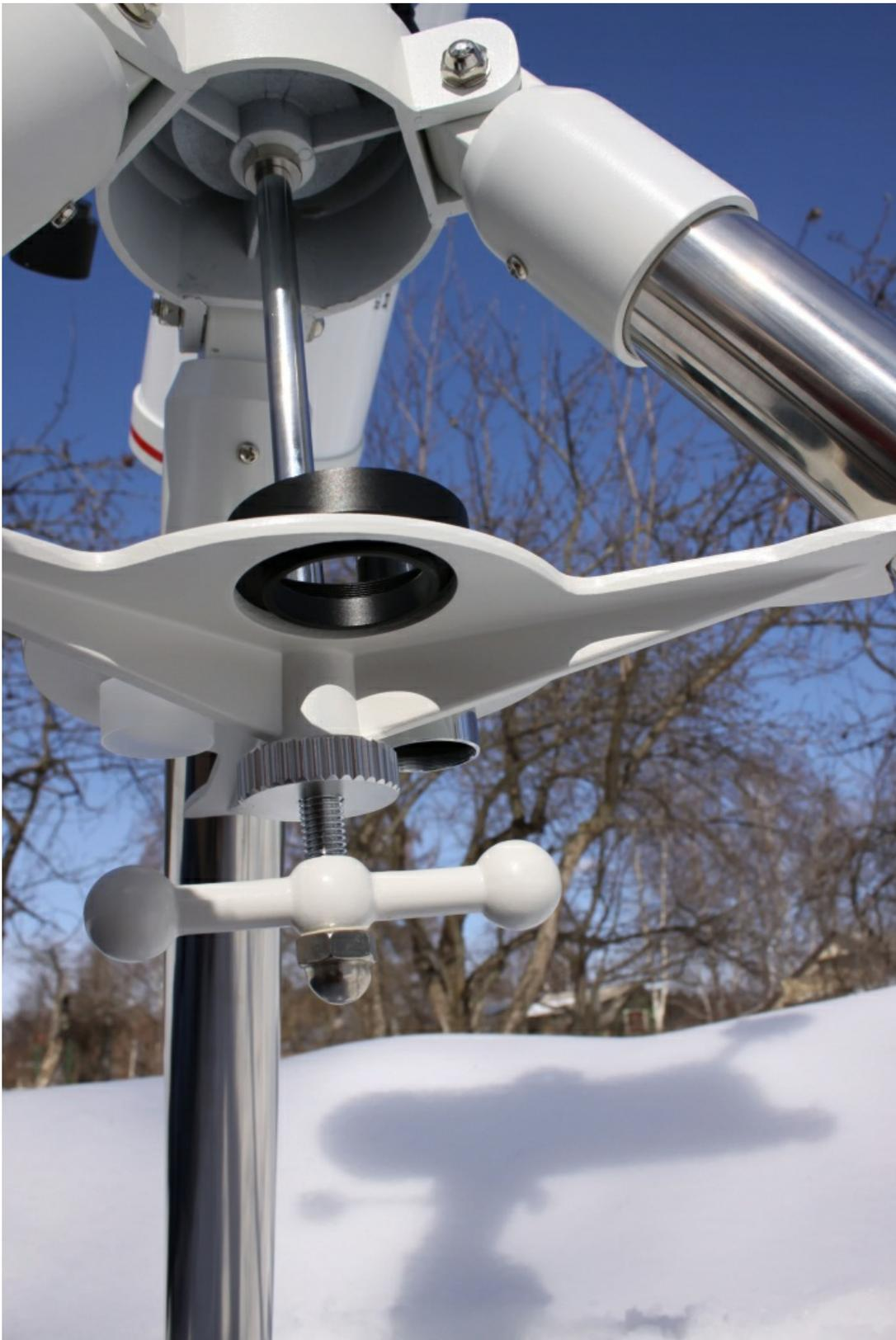
Тренога у BRESSER Messier NT-150L/1200 низкая. Она имеет телескопическую конструкцию, и ее высота может настраиваться с учетом роста наблюдателя. Дополнительным элементом, придающим жесткость треноге, является паук и столик для аксессуаров, на котором можно разместить окуляры стандартов 1,25" и 2".
