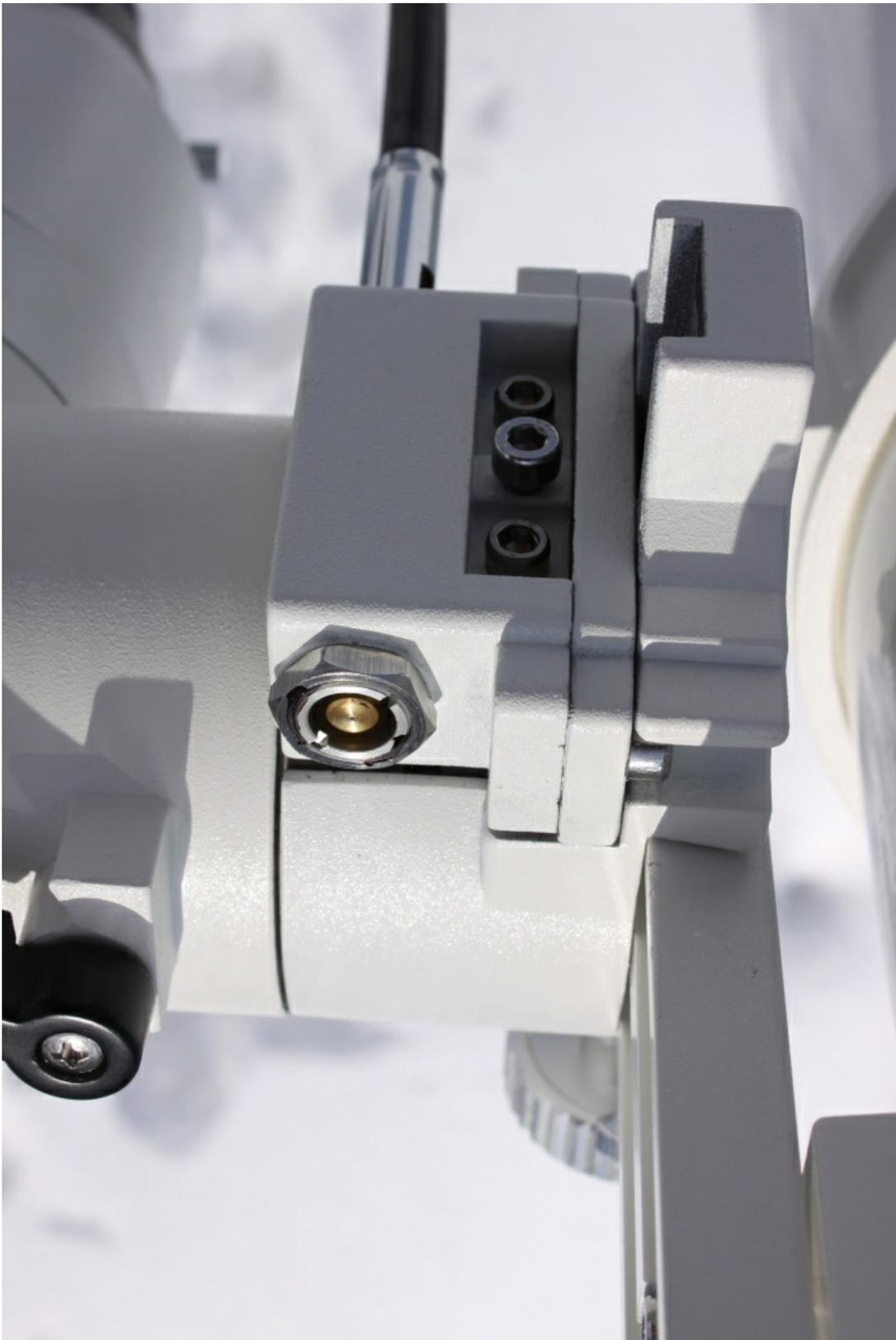
Рейка крепления к монтировке укреплена двумя стальными ребрами жесткости. При необходимости наблюдать небо в другие телескопы или фотографировать разными объективами, трубу можно легко снять с рейки и поставить любое дополнительное оборудование.
