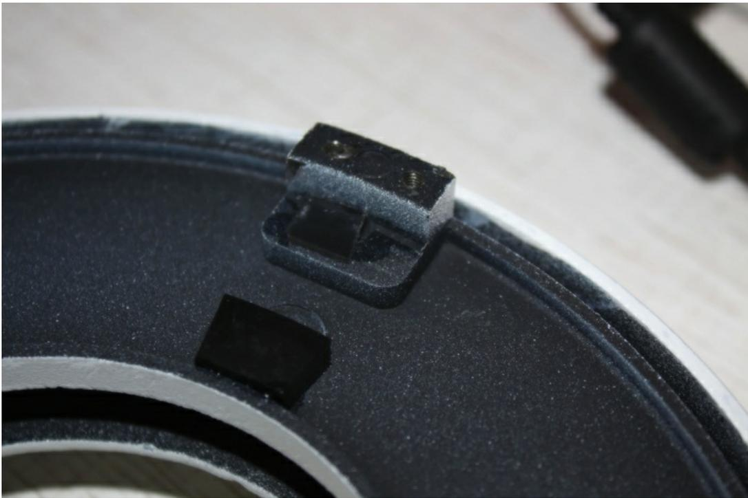
Вторичное зеркало было снято с блока. Поверхность блока я очистил от клея, который приводил к деформации. Затем я переклеил вторичку на мягкое основание.
