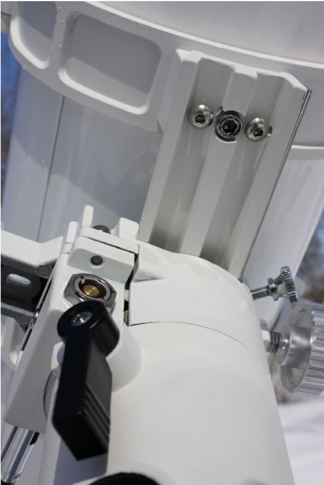
Ручка винта крепления в ласточкином хвосте довольно большая. При правильной фиксации чувствуется нагрузка, на которой нужно остановить вращение. Обратите внимание, что стопорный винт должен быть всегда закручен.
