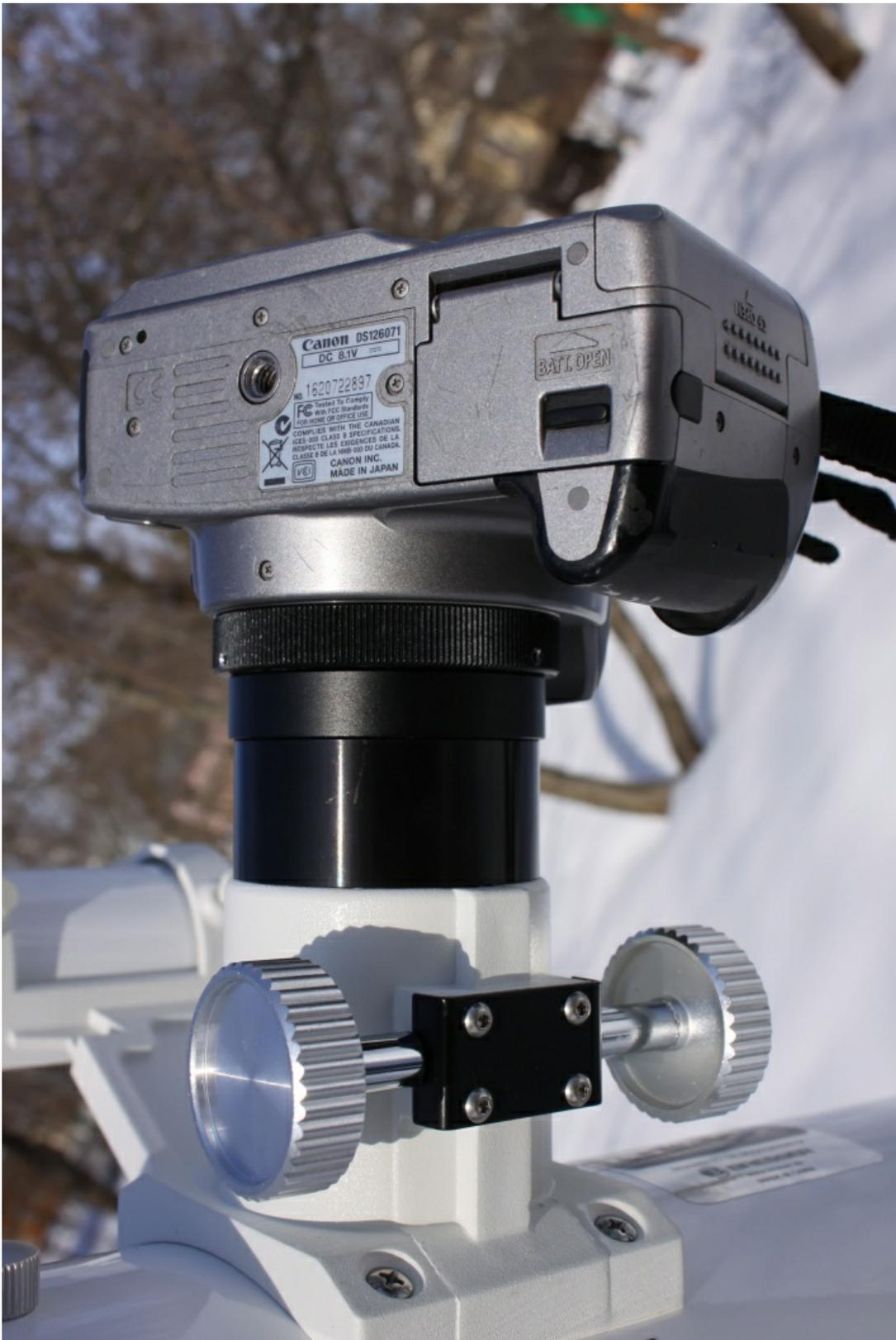
BRESSER Messier NT-150L/1200 можно использовать и в качестве гйда для астрофотографии. При этом в качестве астрографа может выступать как другой телескоп с камерой, так и обычный фотоаппарат.
