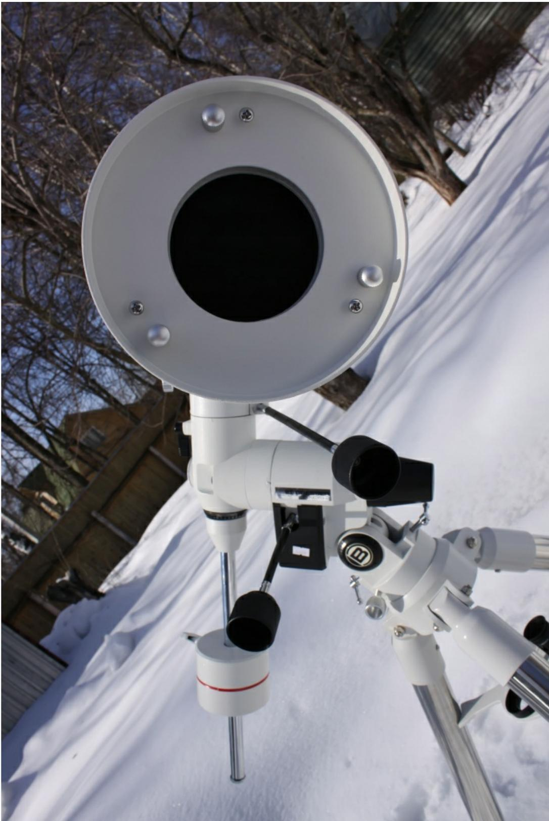
Юстировочные винты массивные. Телескоп можно ставить в вертикальное положение на пол или любое прочное плоское основание и при этом винты не будут его касаться.
