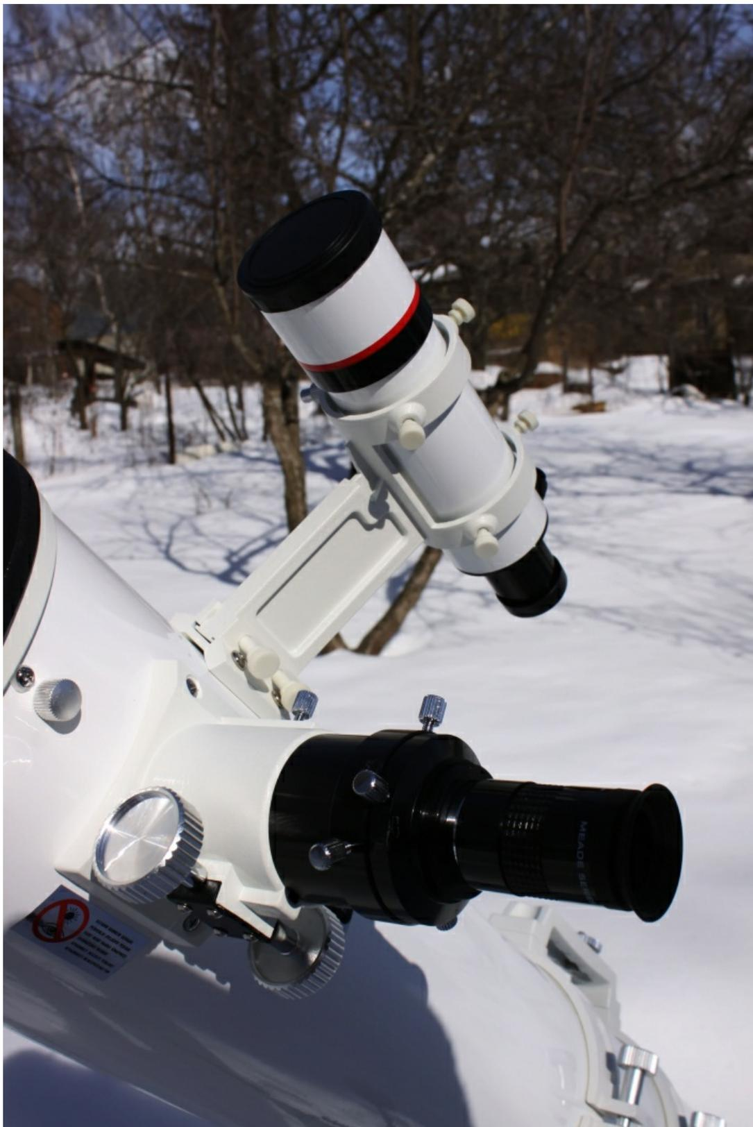
Крышка прекрасно защищает оптику от грязи и пыли. Раз в год или два главное зеркало телескопа можно промывать под струей холодной воды. Я обычно протираю ватой, смоченной в ацетоне.
