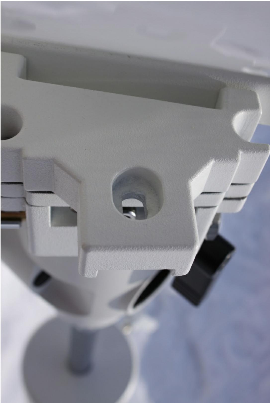
Гибкие ручки управления телескопом устанавливаются на ось червяка. Чтобы выставить монтировку, на полюс необходимо повернуть ось склонений, наблюдая, чтобы отверстие в оси было открыто.
