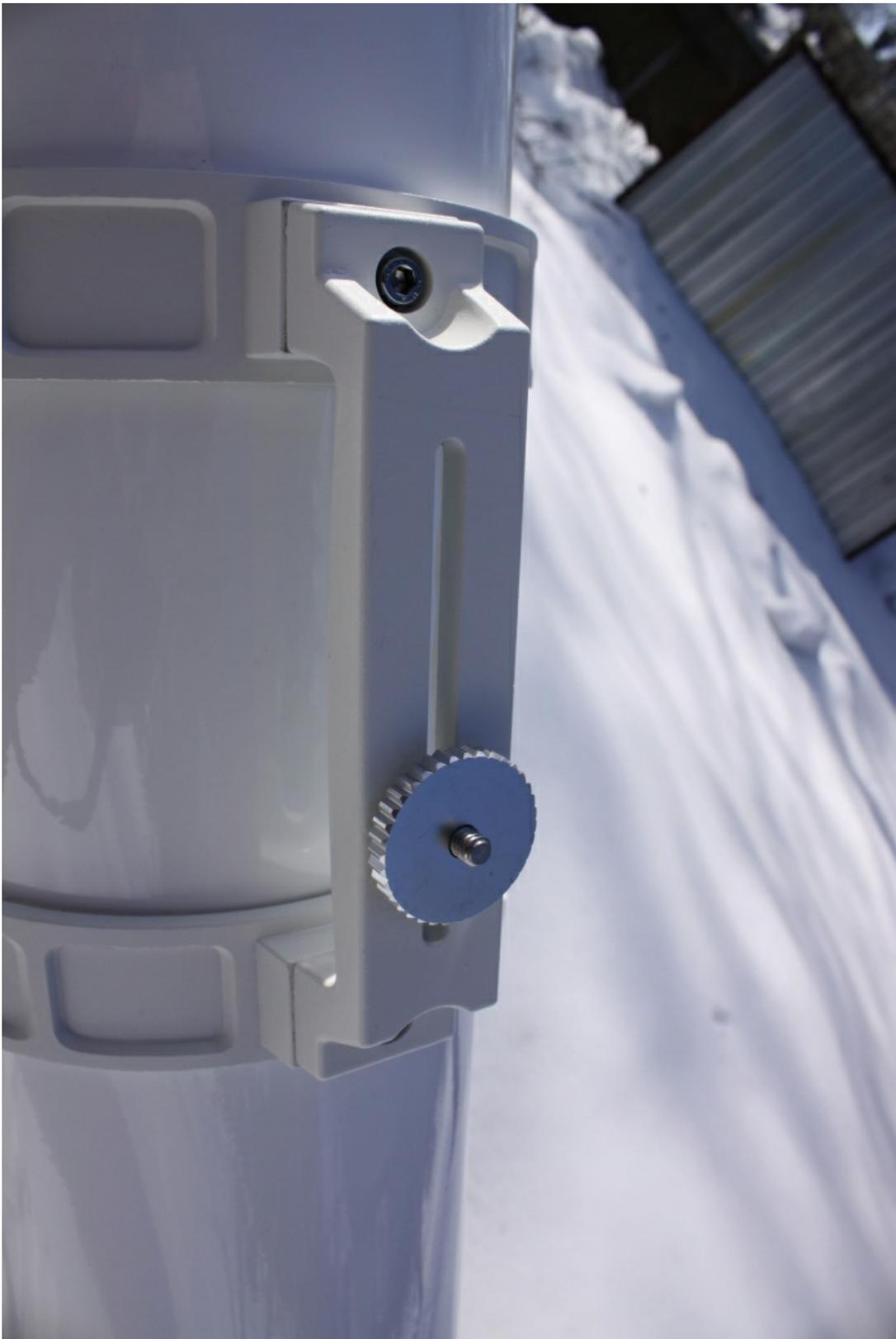
Винты в хомутах достаточно массивные и не следует их зажимать слишком сильно. Замкнутая конструкция крепления трубы в хомутах позволяет размещать на ручке дополнительное оборудование, имеющее довольно большой вес. Это может быть даже второй телескоп, поэтому штангу противовеса у этой модели сделали длинную. Это хорошо продуманное решение.
