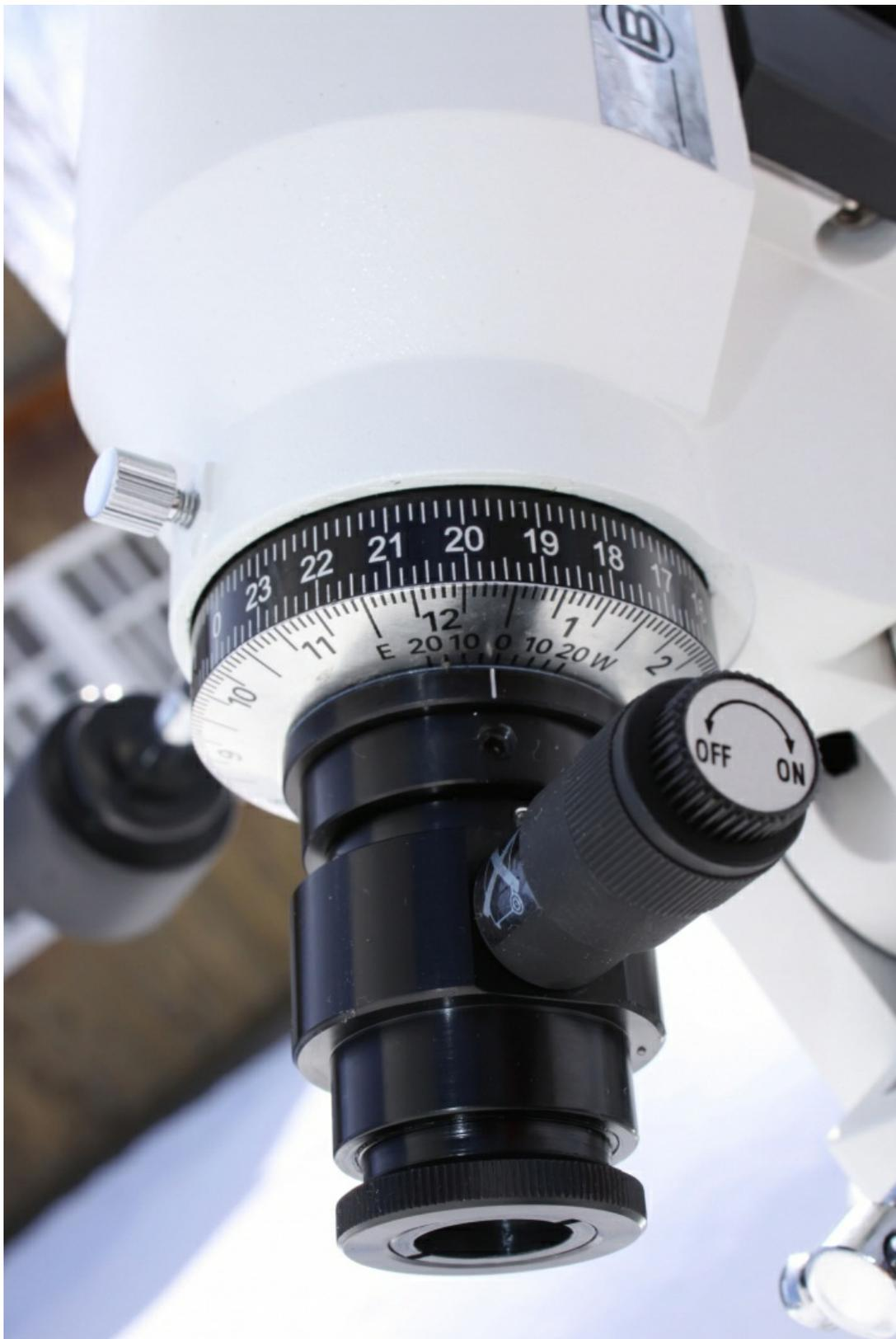
На каждой из осей установлены винты для регулировки плавности хода червяка в червячной передаче. Этими же винтами устраняют люфт в червячной передаче. Выбирать люфт до конца я не рекомендую. Также обращаю ваше внимание, что на хорошо сбалансированном телескопе ручки фиксации зажимают слегка, без усилия.
