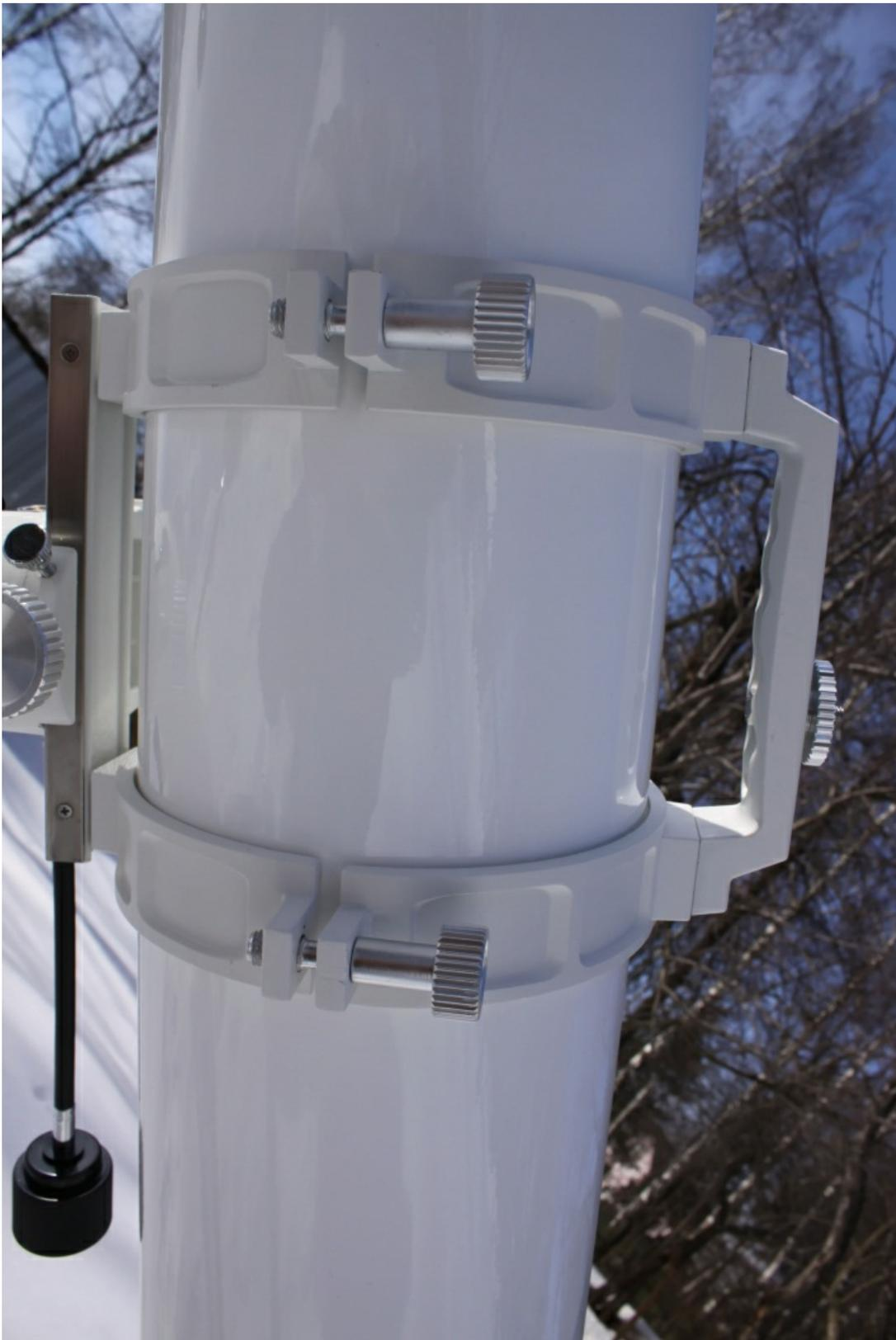
Ручки управления тонкими движениями по осям монтировки хорошо гнутся и это позволяет наблюдателю не покидать своего места и управлять телескопом из любого положения.
