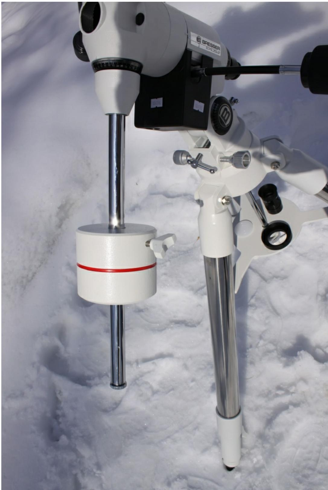
Винты выставления полярной оси должны быть затянуты с небольшим усилием. Сборку треноги проводите очень тщательно! При сборе паука обратите внимание на втулку, которая устанавливается на верхнюю часть оси.
